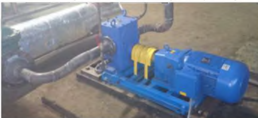
Фото 4.3., 4.4. – Насосный агрегат шестеренный НМШПГ 120-10-30/6с частотным преобразователем.
